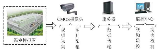
图 1 温室植物病害远程监测系统
